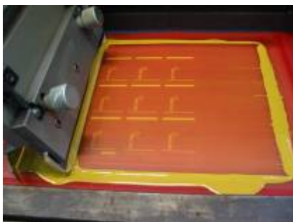
Différents types de machines de sérigraphie à plat
